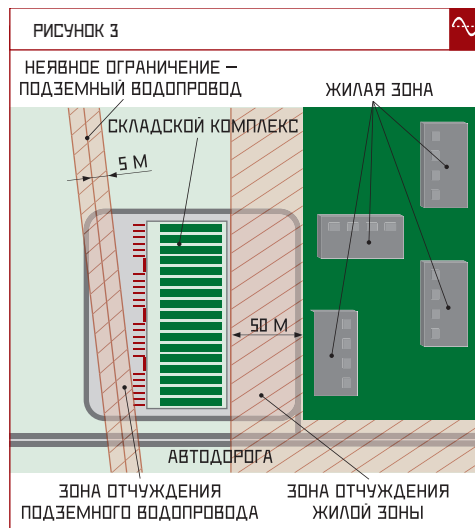
ЭСКИЗНЫЙ ПРОЕКТ СКЛАДСКОГО КОМПЛЕКСА ПОСЛЕ НАНЕСЕНИЯ ОГРАНИЧЕНИЙ (ПРОМЫШЛЕННАЯ ЗОНА)
